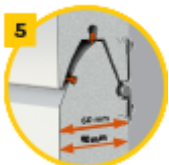
5 Isolasjon Høg isolasjonsv erdi 40 mm standard.
